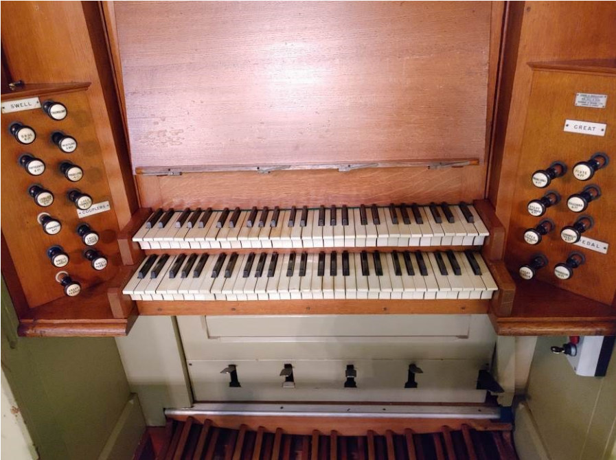
Afb. 10. De claviatuur van het Atterton-orgel; hierbij zijn goed de vier treden voor de vaste combinaties te zien en geheel rechts de voor Engelse orgels zo karakteristieke zweltrede; let ook op de vier haakjes onderaan bij de lessenaar, die zo gedraaid kunnen worden dat het daarop geplaatste zangboek open blijft staan.
